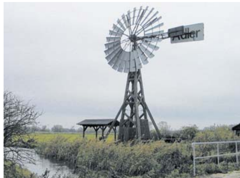
Das Windrad von Kachlin auf der Insel Usedom entwässert das Mooregebiet Thurbruch. FOTO: INGRID NADLER
